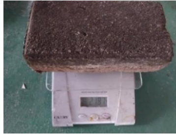
Gambar 6. Berat Beban per 1 Batako Figure 6. weight of load per 1 brick Sumber: Dokumentasi Pribadi, 2025
