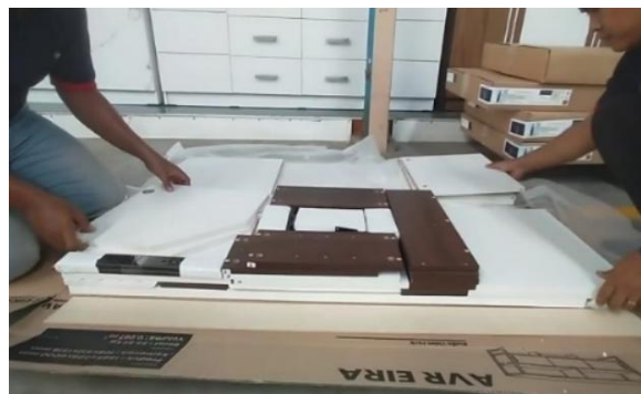
Gambar 12. Proses Pengecekan Komponen Setelah Drop Test Modern Figure 12. Component Checking Process After Drop Test Sumber: Dokumentasi Pribadi, 2025
