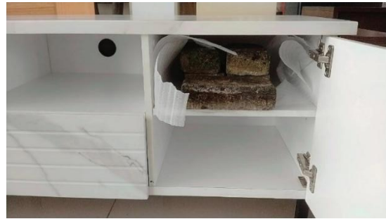
Gambar 8. Uji Beban Rak Tv Stand Figure 8. TV Stand Rack Load Test Sumber: Dokumentasi Pribadi, 2025
