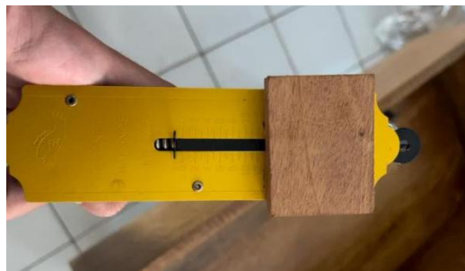
Gambar 4. Alat Force Gauge untuk Uji Gaya Horizontal Figure 4. Force Gauge for Horizontal Force Testing
